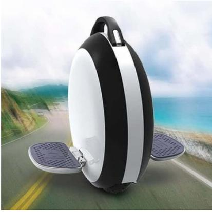
**Моноколесо** — тот же гироскутер, только с одним колесом. Балансом моноколеса управляют датчики наклона и гироскопы, расположенные в самом колесе. Главное условие, необходимое при его управлении, — умение держать равновесие. Максимальная скорость — до 15 км/ч. Вес не превышает 10 кг.
