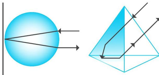
И в том и другом случае свет от источника падает на поверхность микролинзы, преломляется, отражается от внутренней поверхности и возвращается к источнику. **Этим достигается оптический эффект возвращения светового потока.**
